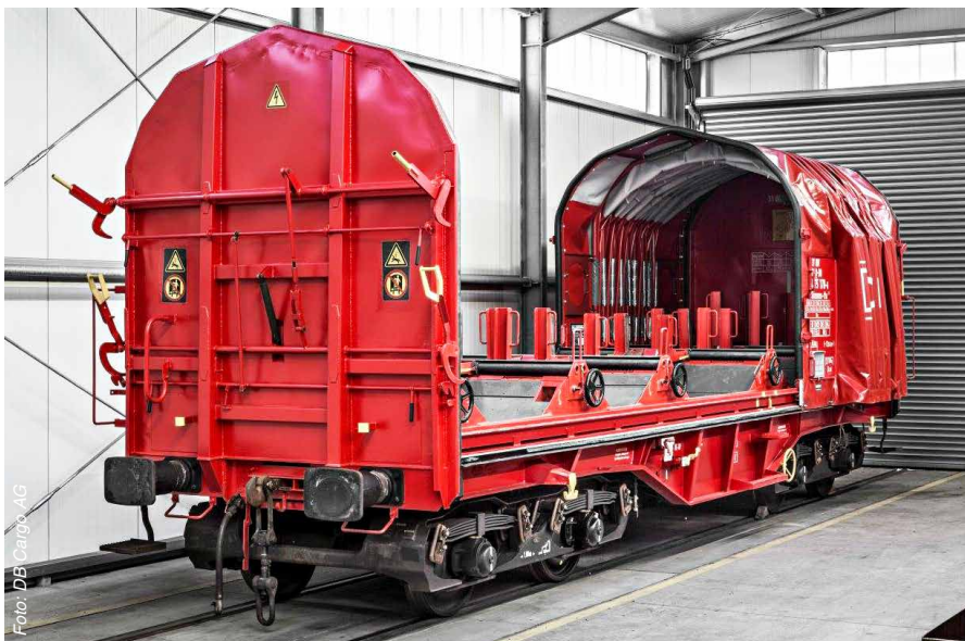
Sukzessive werden alle Güterwagen der DB Cargo-Flotte mit modernster Funk- und Sensortechnik ausgerüstet, hier der Schiebewandwagen Shimmns 708.4
