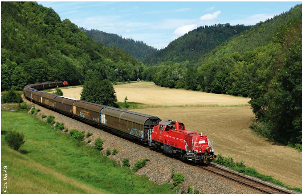
Die Gravita-Rangierlokomotiven mit Partikelfilter halten im Vergleich zum Vorgängermodell 97 Prozent der Rußpartikel zurück
